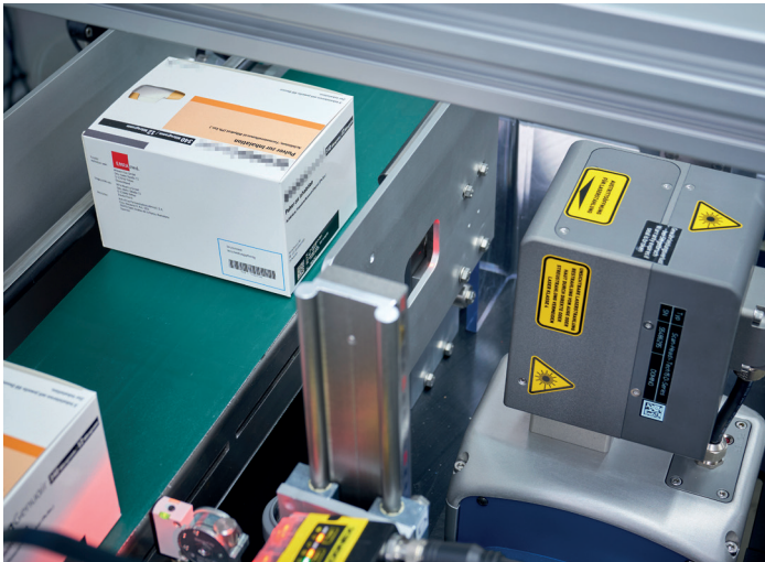
Verifizierung der individuellen Serialisierungsnummer mittels 2D-Code Scan
